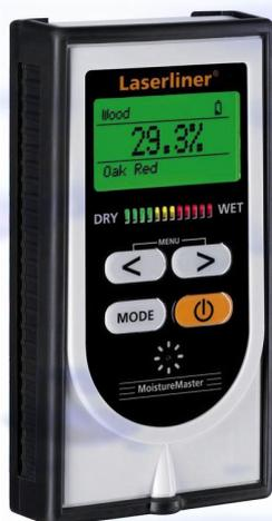
Il s'agit d'appareils dont le capteur est fixé sur l'appareil (non déporté), et se pose sur le support à tester. Le capteur est donc bien en contact avec le matériau, mais comme il ne pénètre pas, on parle d'appareil "sans-contact" en comparaison aux modèles avec pointes qui sont parfois appelés humidimètres de "contact".
