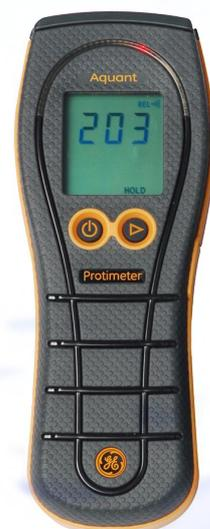
Appareils dont le capteur déporté ou non est à apposer sur la surface du matériau, et permet d'effectuer une détection sans dégradation du matériau (non-invasif) en surface et en profondeur, et appareils se basant sur la méthode de prélèvements d'échantillons de matériaux.
