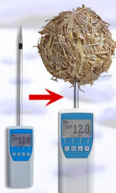
Le principe de mesure est quasiment le même que pour l'humidimètre "sans-contact", sauf que cette fois-ci, le capteur est placé au bout d'une sonde longue. Cette méthode permet des mesures au milieu de tas & balles de foin par exemple, et aussi de biomasse (plaquettes de bois, pellets, écorces, etc... si on ne souhaite/peut pas effectuer de prélèvement d'échantillons), ou encore dans le papier (ramettes, rouleaux....), la tourbe, etc.....
