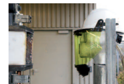
Kit de protection MSA avant le test à l'arc électrique en chambre d'essai 7 kA
