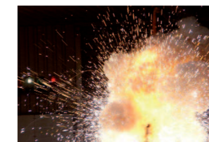
Arc électrique 7 kA
